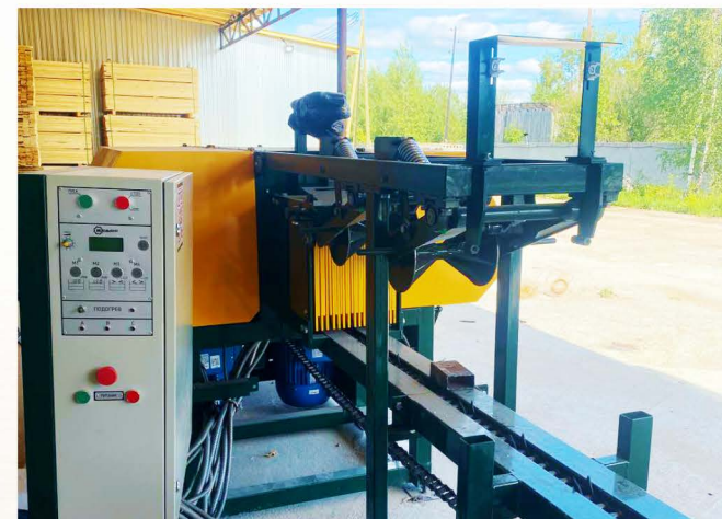
Линия переработки тонкомер УПТ-250С
